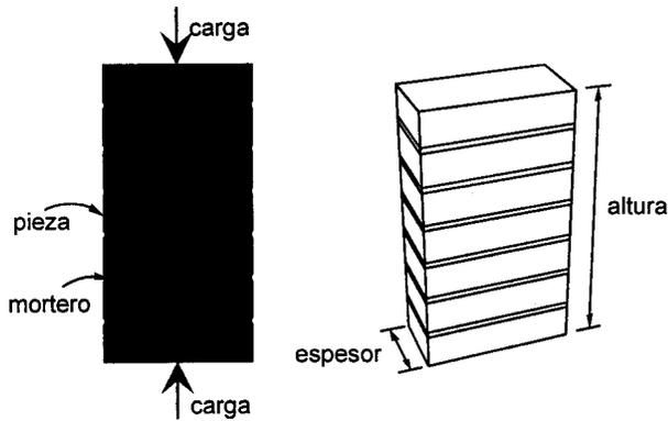
Figura 2.2. Pila para prueba en compresión
