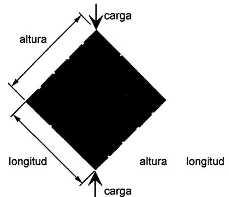
**Figura 2.3 Murete para prueba en compresión diagonal**
