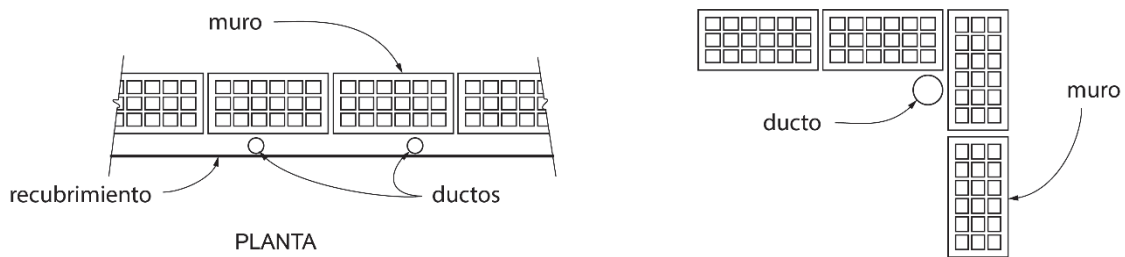
Figura 0.2 Ejemplos de ductos fuera del muro
